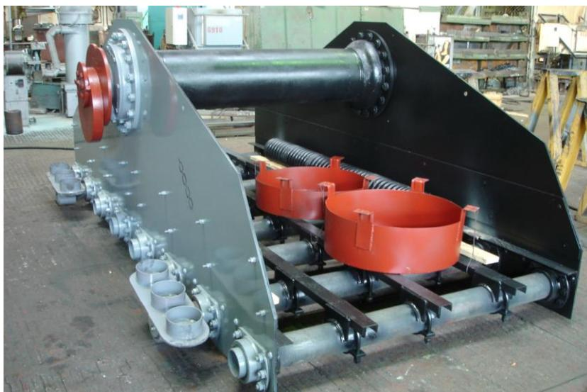
Грохот инерционный ГИТ41Б предназначен для отсева руды на два класса по крупности.
