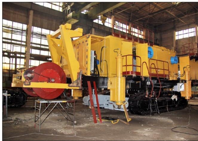
Буровой станок СБШ 250 МНА-32КП с отрывной кабиной в процессе сборки
