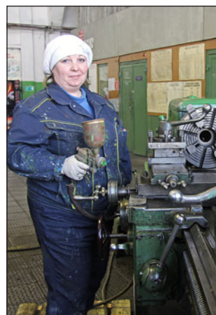
Светлана Ивановна красит токарно-винторезный станок после капремонта
