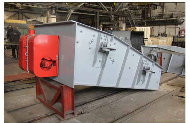
Питатель в промывочно-сортировочном комплексе регулирует подачу насыпного материала из бункера
