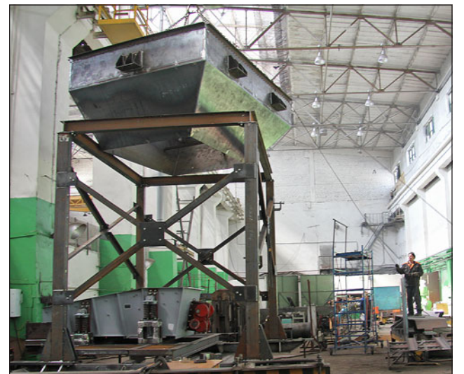
Процесс установки бункера на раму. Бункер ещё называют «ванной». В неё сыпается неочищенный материал
