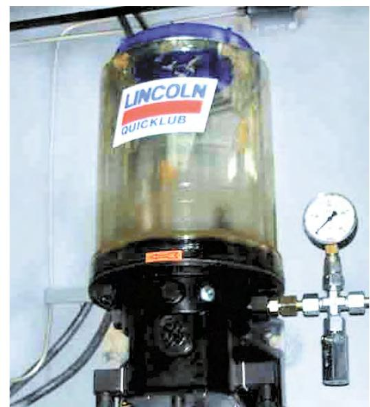
Система автоматической смазки
