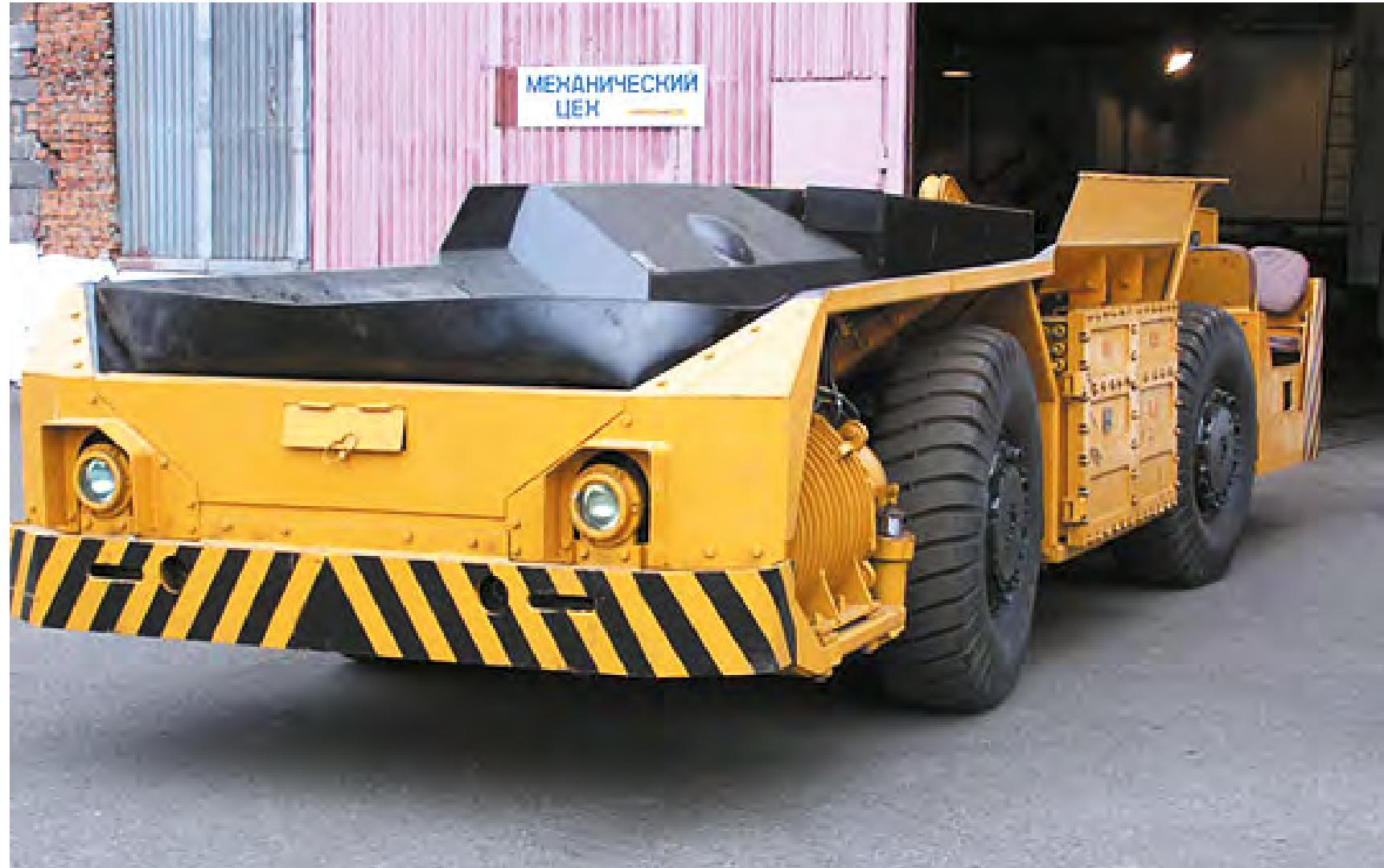
Привод хода оснащён двумя трёхскоростными двигателями; все колёса приводные и управляемые. Передний мост - балансирующий, задний крепится к раме болтами. Рулевое управление - с гидроусилителем на базе «гидроруля».
