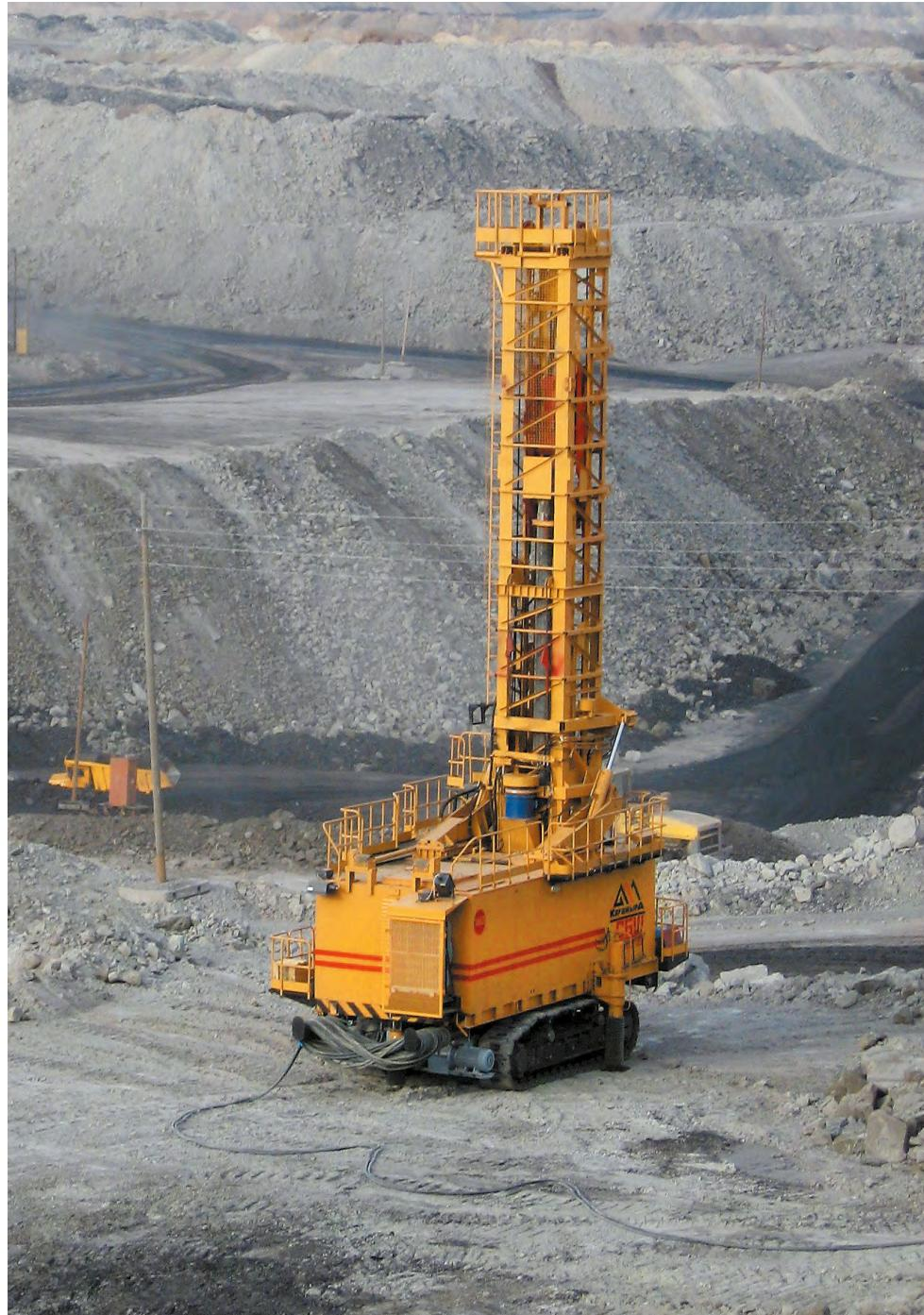
Модернизация серийных буровых станков СБШ-250 МНА-32, проведенная за последние 7-8 лет, позволила увеличить производительность на железорудных карьерах на 67% до 6000 п.м. в месяц.
