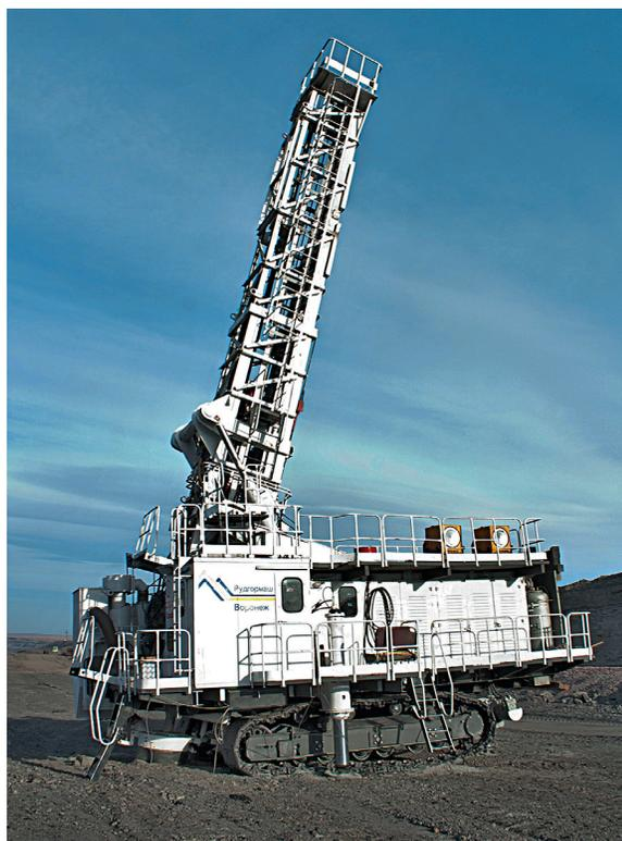
Станок буровой СБШ-250Д с дизельным двигателем в угольном разрезе АО «Хакассвзрывпром»
