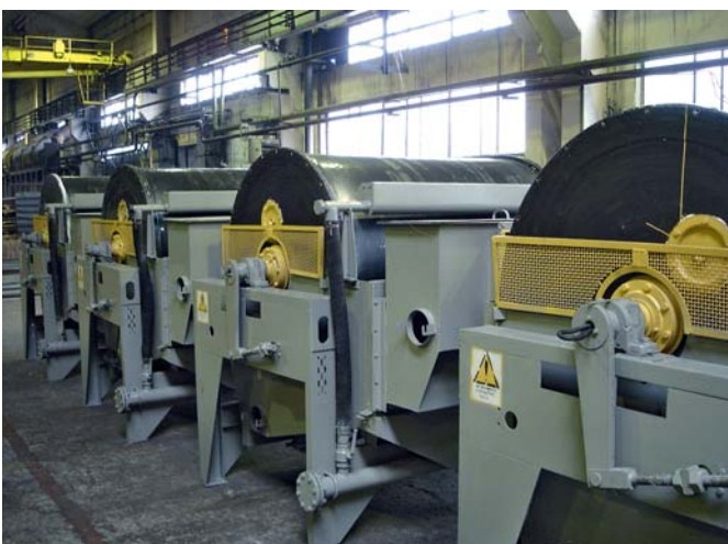
Сепараторы ПБМ в сборочном цехе предприятия
