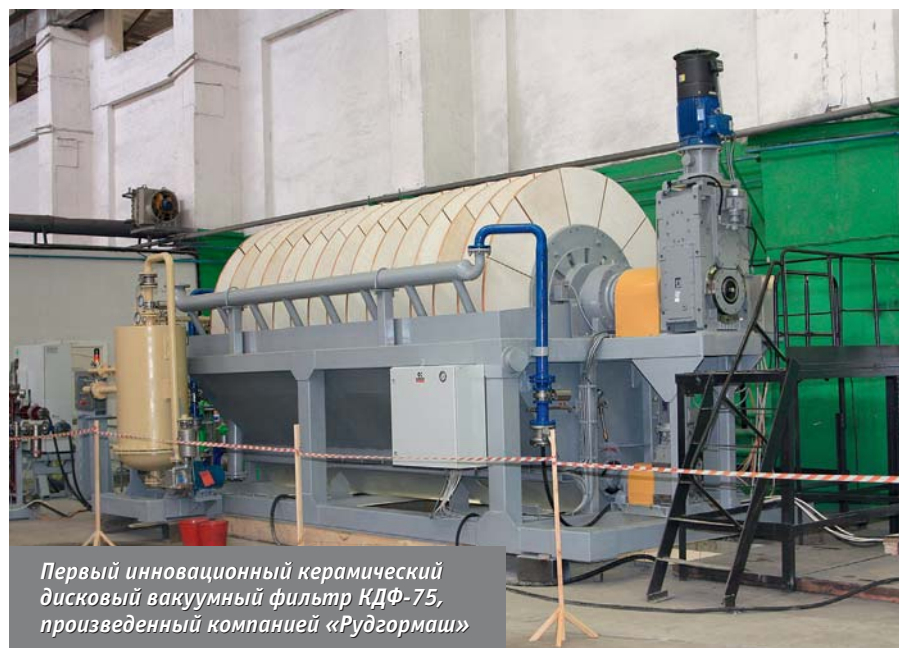
Керамические фильтрующие элементы, созданные ЗАО «НТЦ «Бакор» по инновационным технологиям
