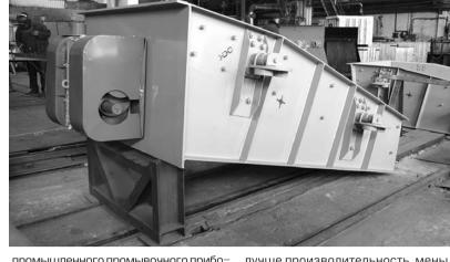
ра для золотоискателей. Он предназначен для отработки небольших месторождений золота и вторичной переработки техногенных россыпей.
