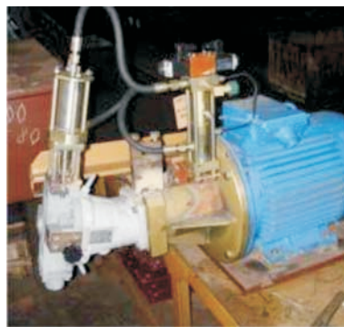
Основной насос с регулируемой производительностью The main pumps with controlled output
